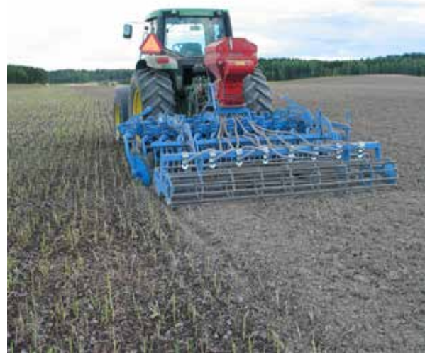
Piensiementen kylvölaitteen voi liittää suoraan muokkaukseen. Kuva: Juuso Joona.
