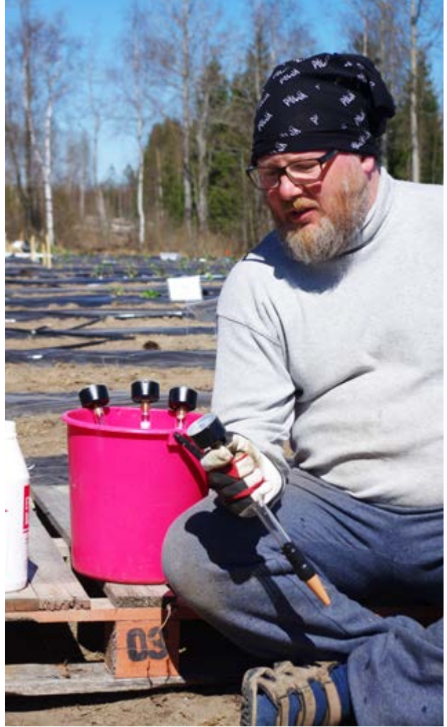
↑ Tensiometri on investoinneista kaikkein pienin, alle 100 €. Se avulla seurataan maan kosteutta ja se auttaa päättämään, milloin tarvitsee kastella.
