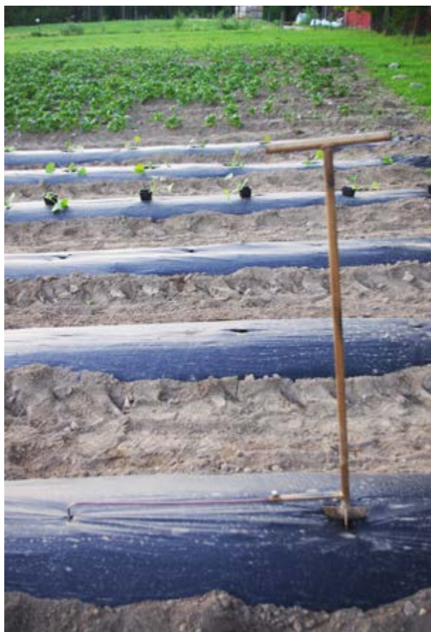
↑ Kuvan rei'ittämissä on merkitsin, joka tekee pienen piston seuraavan reiän paikalle. Haluttu taimiväli saadaan, kun avataan mutteri ja siirretään merkitsin sopivalle etäisyydelle.
