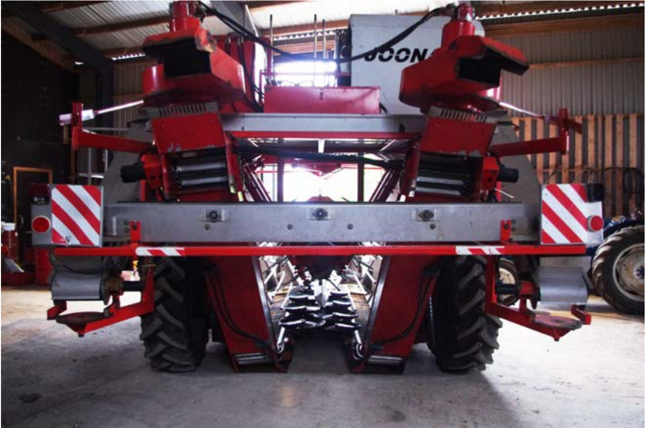
↑ Kotimainen Joonas-herukanpoimintakone on itsekulkeva. Tässä kone takaapäin.
