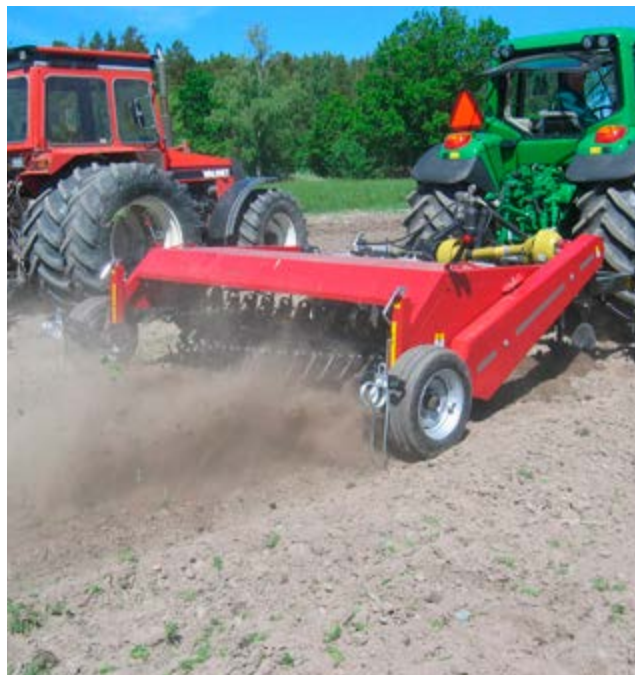
↑ Avokesannoitukseen käytetään yleisesti jousipiikkiäestä, mutta muitakin muokkausvälineitä voi käyttää. Kuvan KvikFinn katkaisee rikkakasvien juuret ja nostaa ne sitten tehokkaasti pintaan.
