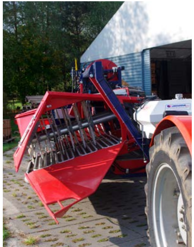
↑ Traktorivetoinen, puoli pensasta kerralla poimiva, puolalainen herukanpoimintakone.
